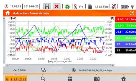
Registrador de los parámetros de alimentación
