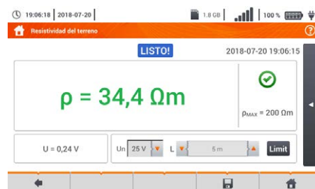
Medición de la resistividad del suelo
