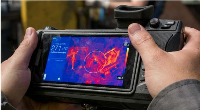
Die Wärmebildtechnik **wandelt Infrarotstrahlung**, also die von Objekten abgestrahlte Wärme, **in ein sichtbares Bild um**. Auf diese Weise lässt sich die Temperaturverteilung auf einer Objektfläche berührungslos darstellen.
