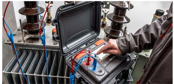
Messung mit dem MMR-650-Messgerät
