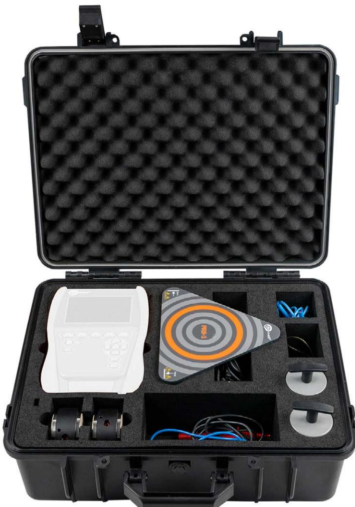
Set zur Messung von Widerstand in ESD-geschützten Bereichen mit Raum für Messgerät
