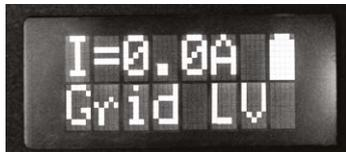
Niederspannungsbetrieb - Das Display zeigt den Wert des gemessenen Stroms an, der durch die Klemmen fließt. Außerdem wird der Ladezustand der Batterie angezeigt
