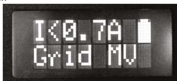
Mittelspannungsbetrieb - Das Display zeigt den Wert der eingestellten Alarmschwelle sowie den Ladezustand der Batterie an
