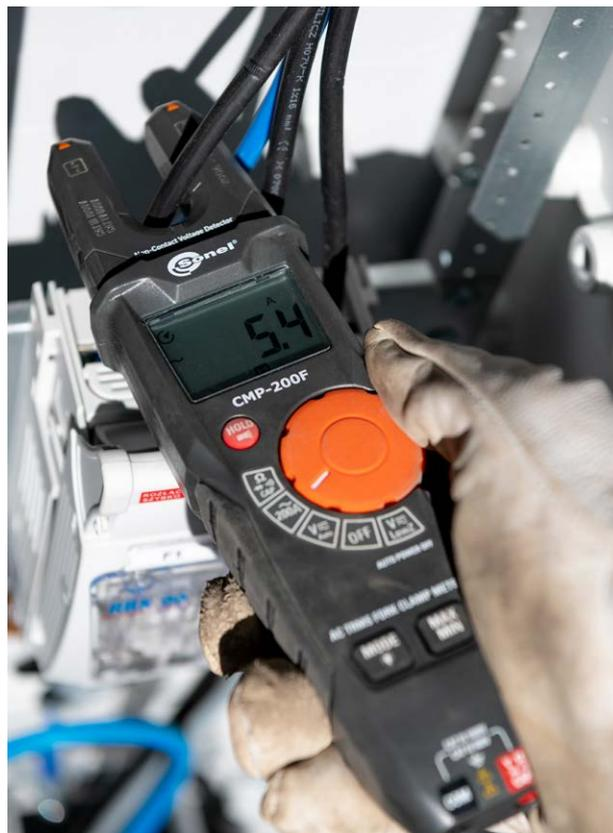
Pinza amperométrica de corriente de fuga
