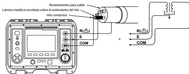
El uso del método de 3 conductores es importante en caso de medir los objetos con los valores de resistencia muy altos (100 M)
