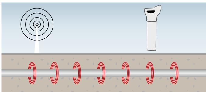
**8 kHz** - se utiliza para la localización exacta de una instalación específica (cable, tubería, etc.). La frecuencia de la señal de 8 kHz generada tiene un mayor rango que el de 33 kHz y tiende menos a penetrar en otros objetos. Dicho método es un método activo ya que exige el uso del generador de la señal.
