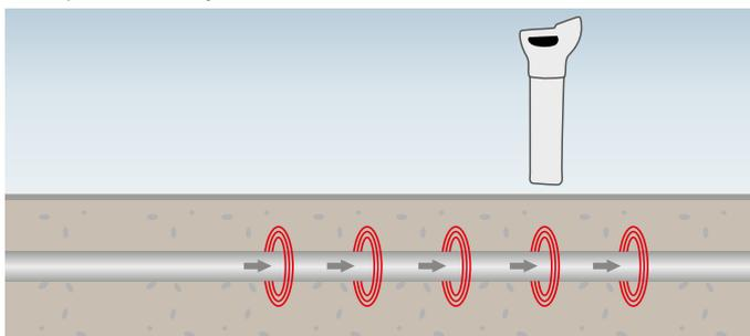
**De radio** - empleado para la localización de los objetos de metal (tuberías, armamentos) que reemiten las señales de radio. También es un **método pasivo**: la señal ya está en el propio objeto, que retransmite las ondas de radio.
