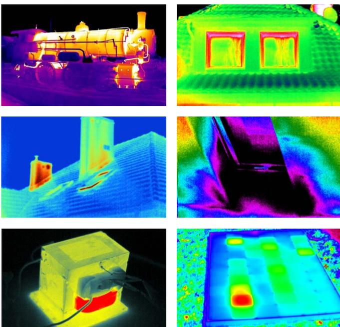
Toda la información almacenada en el termograma puede ser utilizada por un software especializado incluido en la cámara de formación de imágenes térmicas. Durante el análisis del termograma, se pueden determinar los puntos de temperatura máxima o mínima, se puede corregir el coeficiente de emisividad de una parte o de todo el termograma, también se puede leer la temperatura en cualquier punto del termograma, se puede calcular la temperatura media, se puede presentar la
