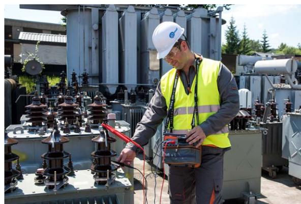
Medidor de resistencia de aislamiento
