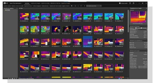
Registro de todas las correcciones realizadas y de los puntos característicos para permitir el análisis en un momento posterior. Selección de la paleta de colores visualmente óptima (de 9 disponibles en el programa) para la mejor representación visual de los cambios de temperatura. Determinación del rango de las temperaturas para una mejor visualización de su distribución (posible el modo manual o automático).
