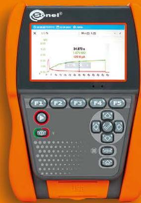
Medidor de resistencia de aislamiento
