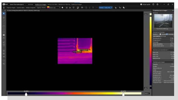
Empleo de la tecnología Infra Fusion – en una parte de la imagen visible se superpone el termograma, en cualquier paleta elegida por el usuario. El termograma se superpone con la transparencia seleccionada, lo que permite mostrar de manera óptima y marcar las áreas interesantes, en particular si visualmente es complicado comparar los lugares del termograma con los detalles de la imagen visible del objeto observado.
