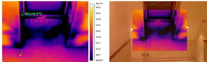
Una característica útil de las cámaras termográficas es la **posibilidad de sacar las fotografías reales y los modos de las imágenes combinadas**, lo que permite combinar la imagen real con la imagen térmica y mostrarla de tal manera que la imagen térmica interfiera con la imagen real.
