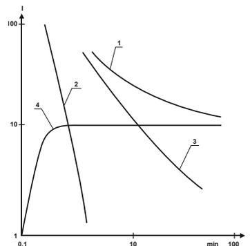
El carácter de la corriente que fluye en el aislamiento hace que el valor de la resistencia del aislamiento medida esté influenciado por el tiempo de medición, pero también por la humedad, la temperatura, la tensión de medición y la limpieza de la superficie del material de aislamiento.
