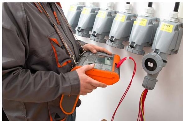
**Medición de la impedancia del bucle de cortocircuito:**
