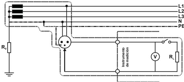
ne posibilitada por las mediciones de la impedancia del bucle de cortocircuito: MZC-304F, MZC-306, MZC-310S, MZC-320S y MZC-330S, así como los dispositivos multifuncionales MPI - todos estos instrumentos también indican los componentes de la impedancia, es decir, la resistencia y la reactancia.
