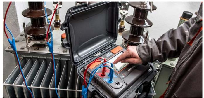
Mediciones mediante el dispositivo MMR-650
