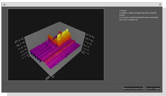
Lectura de la temperatura en cualquier punto – tras pasar con el cursor en la ventana «Información» se indica de forma continua la temperatura leída y las coordenadas actuales y está disponible el resto de información guardada (temperatura máxima, humedad, emisividad).
