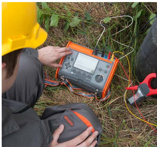
Medidor de resistencia de puesta a tierra y resistividad del suelo
