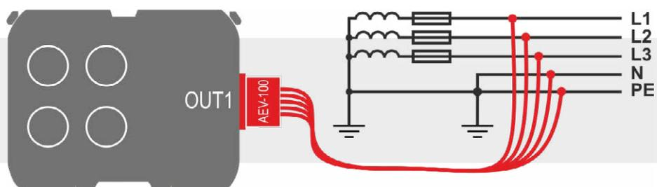
Adaptador para probar estaciones de carga de vehículos
