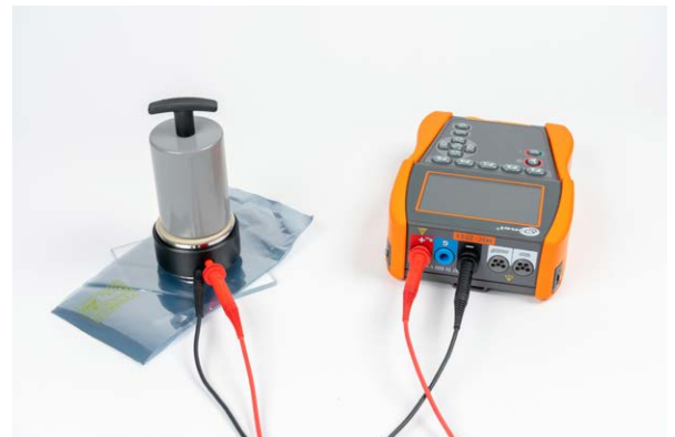
Juego para medir resistencia en áreas protegidas de ESD con espacio para el medidor
