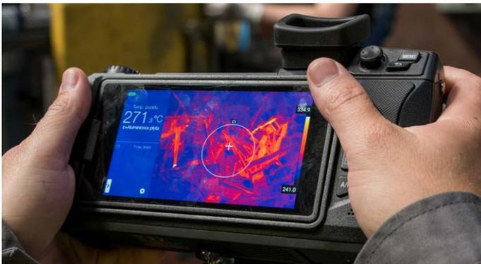
La **termografía** es un proceso consistente en la conversión de la **radiación infrarroja**, es decir, el calor emitido por los objetos, en una **imagen visible**, lo que permite evaluar la distribución de la temperatura en la superficie del objeto observado sin contacto.
